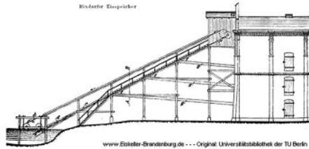
Abb. 5: Elevator vom Eisspeicher in Rixdorf
